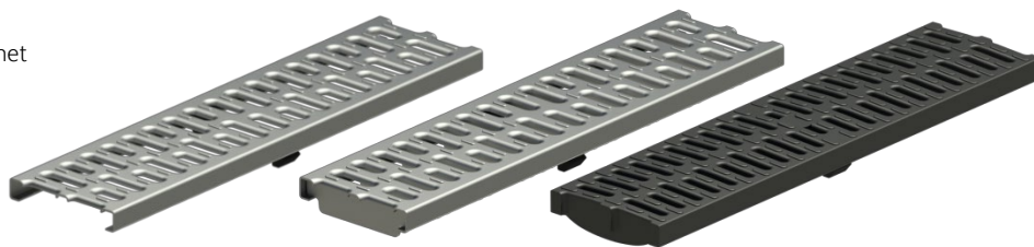
Stegroste nur für Rinnenbreite ca. 155 mm Edelstahl - Klasse A 15 oder C 250 Kunststoff schwarz - Klasse C 250 Incl. Drainlock-Arretierung
