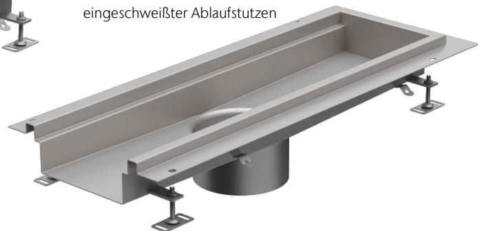
Abbildung: Beispiel Typ 405-HF mit umlaufendem Haftflansch 50 mm, eingeschweißter Ablaufstutzen
